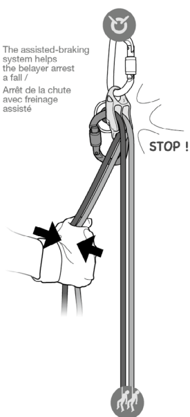
7e. Assisted-braking function disabled by crossed rope / Annulation du freinage assisté par croisement des cordes
